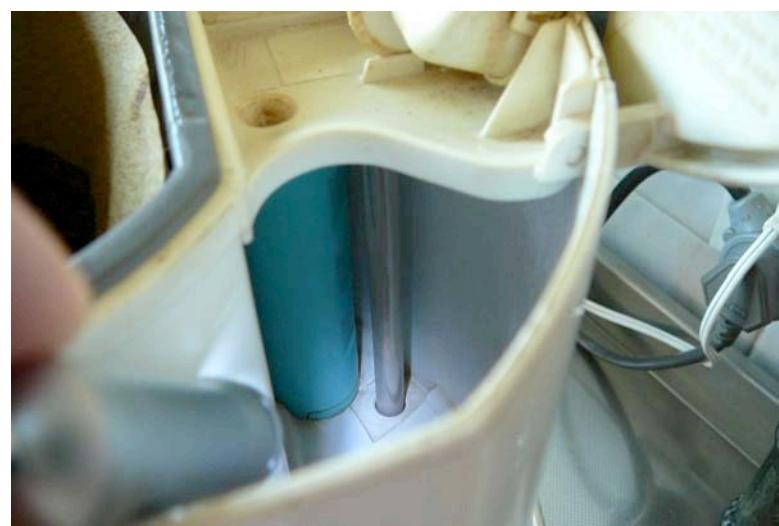
图31——水罐中取代原配塑料管的那根不锈钢管。管子用铝箔来固定到位，恰好合适。
