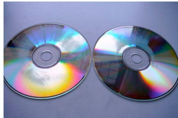
图45——几周后从播放机中取出来的碟片；播放机老说“没有碟片”，那是因为污染让激光头积了污垢。
