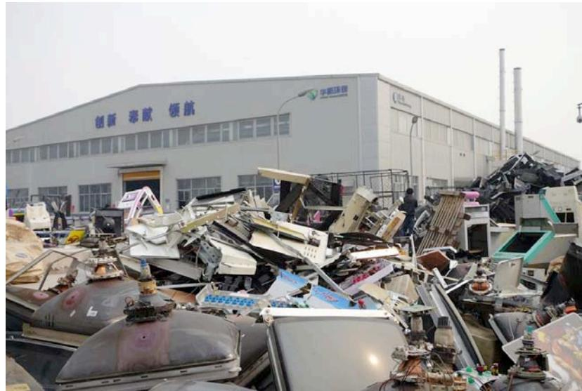
图11——华星厂的收货场，卡车在这里倾倒垃圾，之后工厂做初步分拣。
