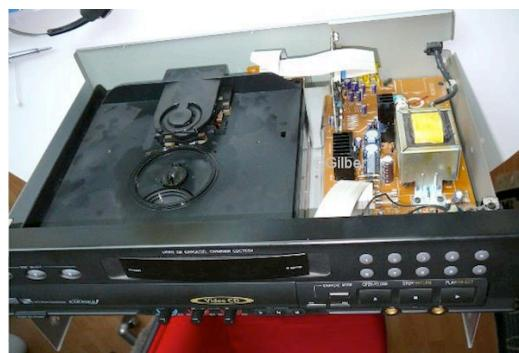
图46——拆了读碟器的“菲利普”三碟VCD播放机，CDC763V。
