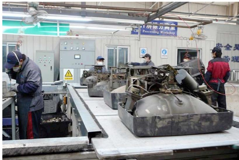
图12——华星厂阴极射线管处理流水线。
